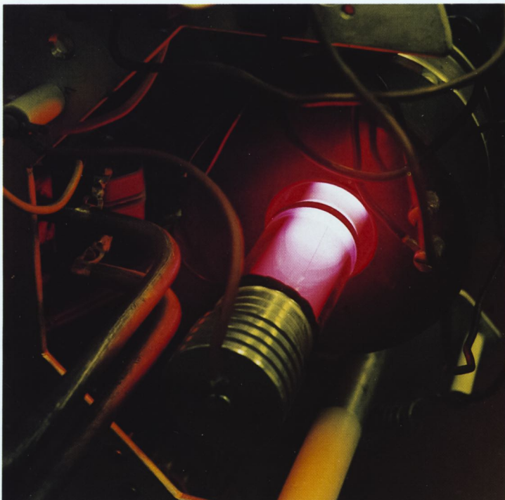
Ströme positiver Ionen und Alphateilchen werden im Van de Graff-Generator fokussiert.
